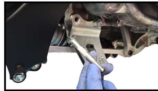
Rimuovere la vite originale dalla staffa cavalletto. Remove the original screw of center stand bracket
