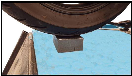
Sollevare la ruota posteriore utilizzando uno spessore. Lift the rear wheel using a spacer
