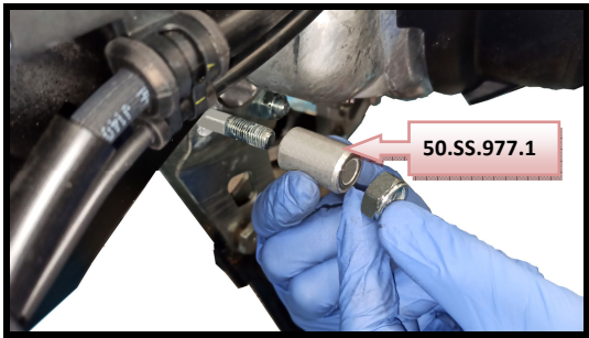
Fissare la staffa del cavalletto utilizzando il distanziale 50.SS.977.1 Fasten the center stand bracket using the spacer (part nr.50.SS.977.1)
