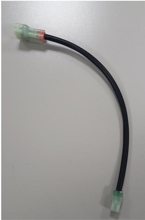
**IT** · Collegare il cavo di estensione (fornito nel kit di montaggio) al cablaggio della sonda lambda
