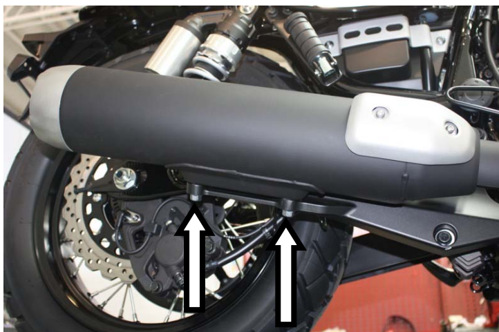
Svitare le viti indicate (2) e rimuovere il terminale Unscrew the screws shown above and remove the silencer
