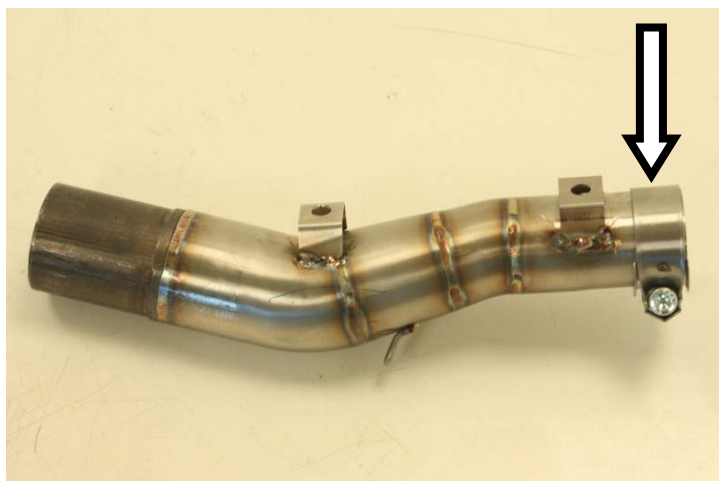
Alloggiare la fascetta nell' innesto del raccordo Fit the hose clip to the link-pipe as shown above
