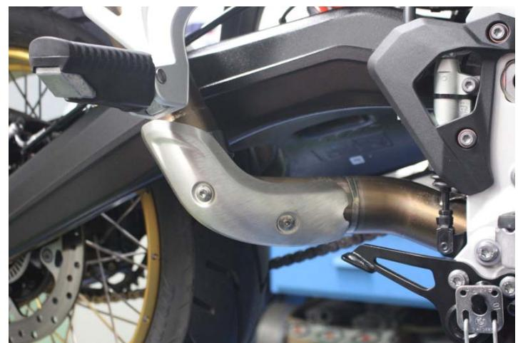
IT · Montare la protezione negli attacchi del raccordo mediante viti originali
