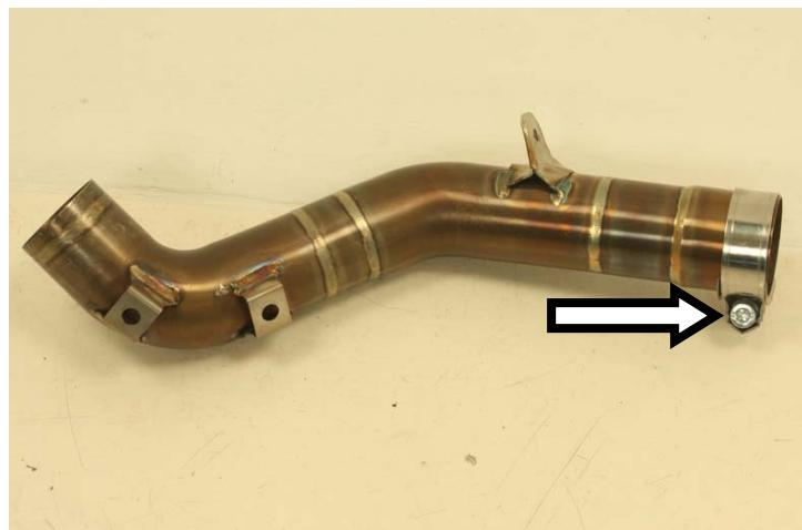
**IT** · Alloggiare nell'innesto del raccordo la fascetta di serraggio
