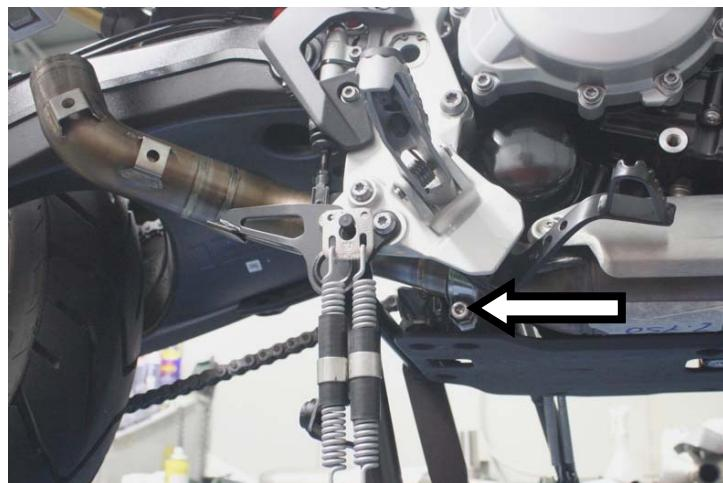
**IT** · Innestare il raccordo, serrare senza stringere completamente l'attacco alla staffa di sostegno e la fascetta
