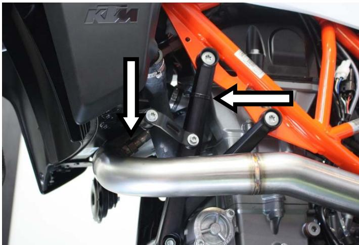
**IT** · Avvitare la sonda lambda e fissare il cavo mediante fascetta
