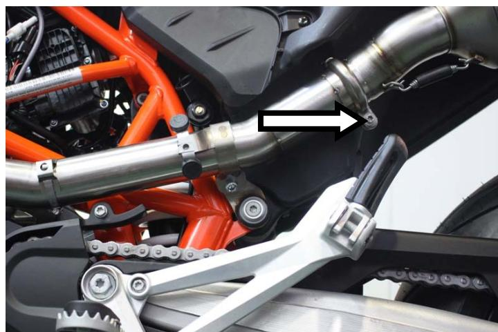
**IT** · Ruotare il raccordo fino a posizionare correttamente il terminale e serrare definitivamente la fascetta
