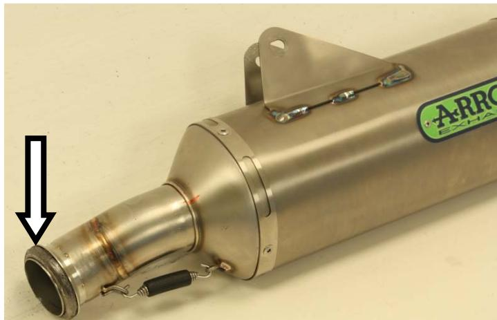
**IT** · Alloggiare la guarnizione originale nell'imbocco del raccordo
