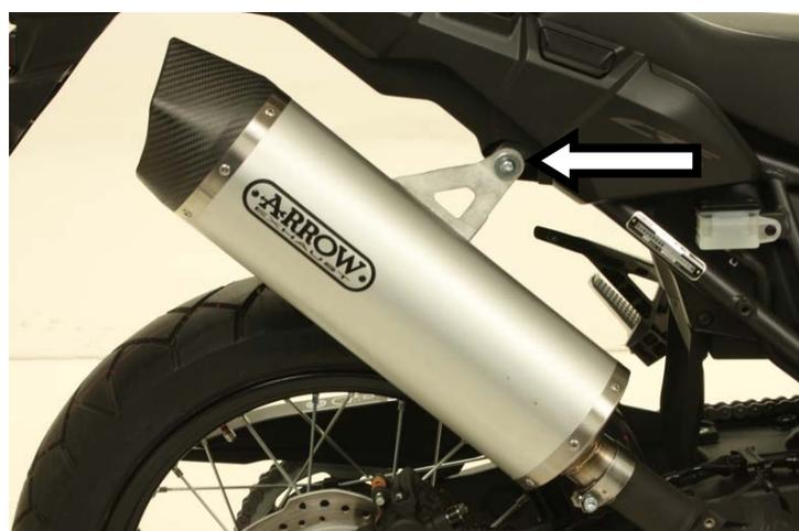
Innestare il terminale e serrare l'attacco al telaio
