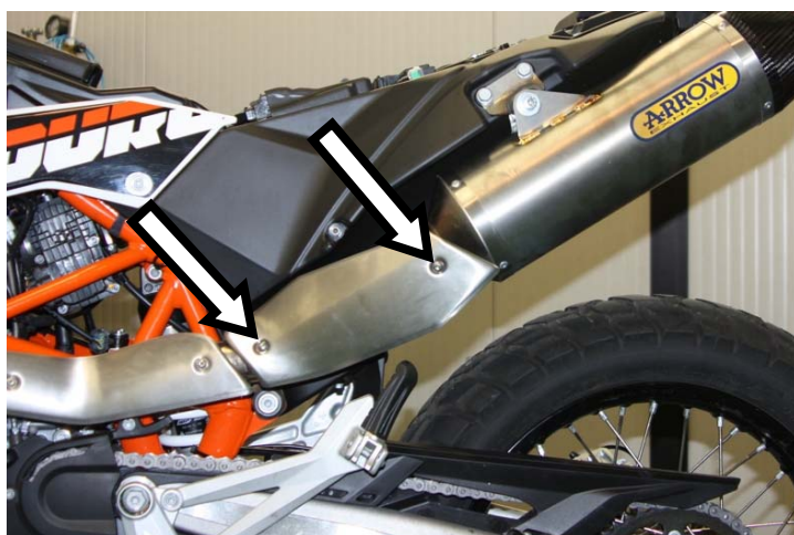
Serrare definitivamente la fascetta tra collettore e raccordo e rimontare la protezione originale Tighten the hose clip between silencer and mid-pipe and fit the rear heat cover
