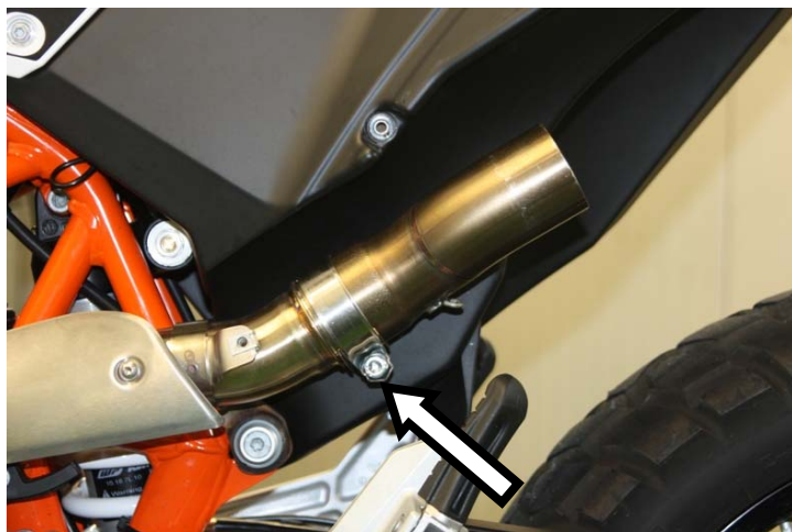
Innestare il raccordo comprensivo di fascetta di serraggio nel collettore Fit the mid-pipe with the hose clip to the collector
