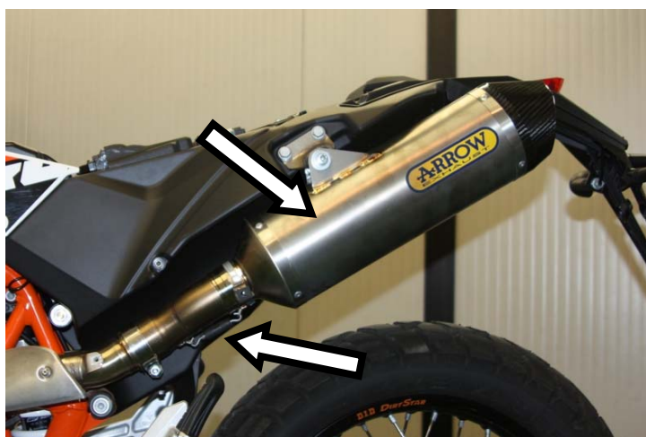
Innestare il terminale, fissare l'attacco alla staffa di sostegno ed ancorare la molla Fit the silencer, secure it to the adaptor and secure the spring
