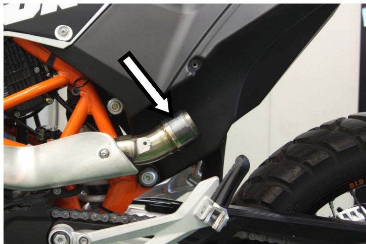
Posizionare la guarnizione originale nel collettore Fit the original gasket to the collector
