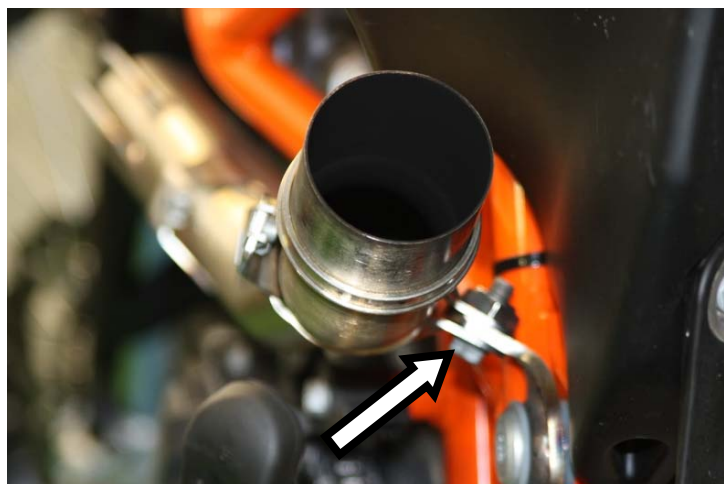
Svitare la fascetta di fissaggio al telaio e rimuovere il collettore originale Remove the clip securing the header to the frame and remove the header
