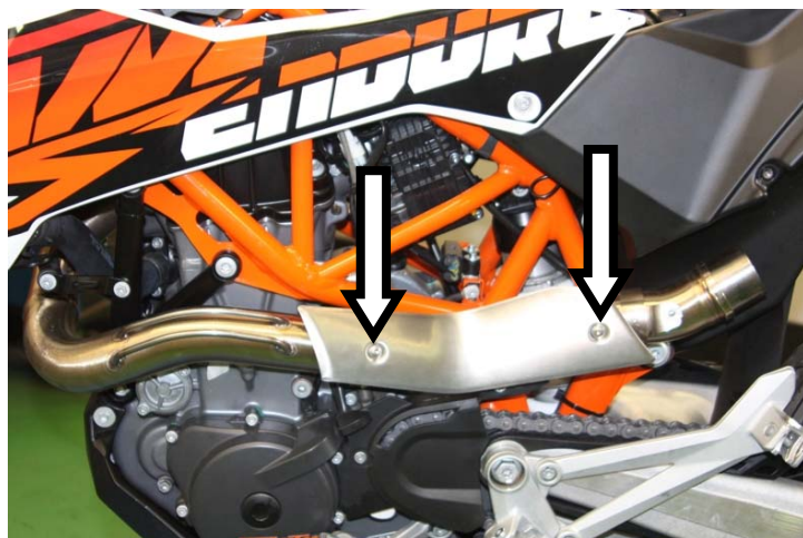
Smontare la protezione anteriore Remove the front heat shield
