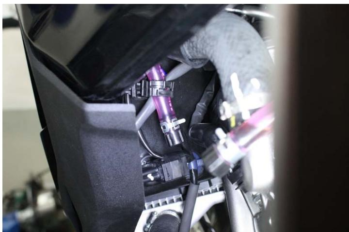
**IT** · Riconnettere i cablaggi delle sonde lambda e riposizionare i cavi come in origine
