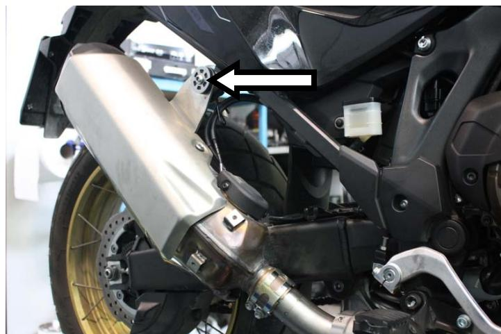
**IT** · Innestare il terminale e serrare senza stringere completamente l'attacco al telaio
