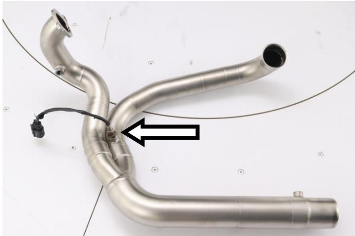
**IT** · Avvitare la sonda lambda nel collettore posteriore Dekat
