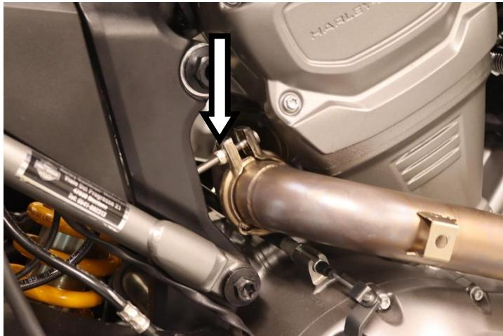
**IT** · Verificare che il collettore posteriore sia correttamente innestato e serrare la fascetta
