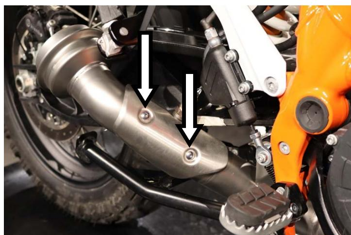
**IT** · Rimontare la protezione mediante viteria originale
