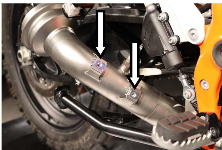
**IT** · Inserire negli attacchi del raccordo le due clip M5 fornite
