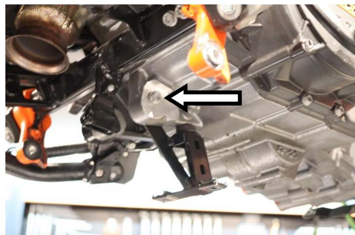
IT · Svitare la vite indicata e rimuovere la staffa di fissaggio para motore
