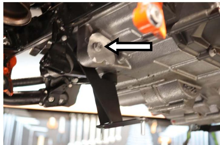
IT · Avvitare al motore la staffa di fissaggio protezione para motore fornita
