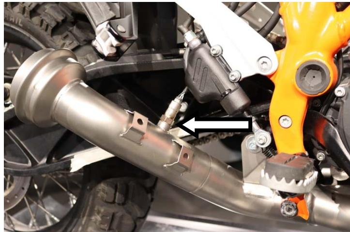
**IT** · Avvitare la sonda lambda nell'attacco del raccordo
