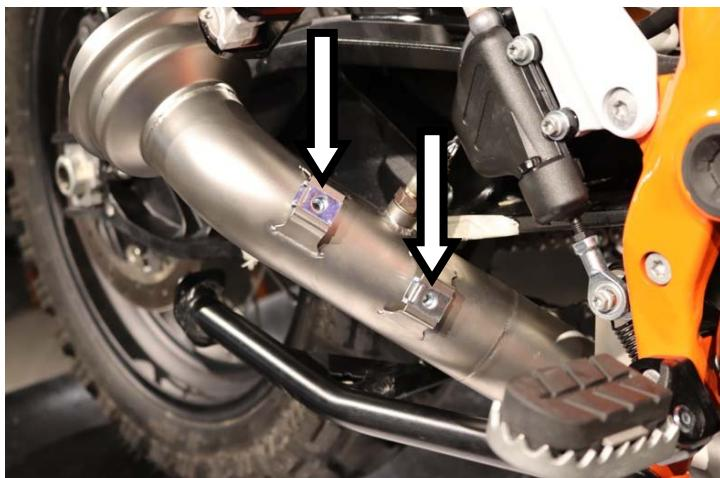
**IT** · Inserire negli attacchi del raccordo le due clip M6 fornite
