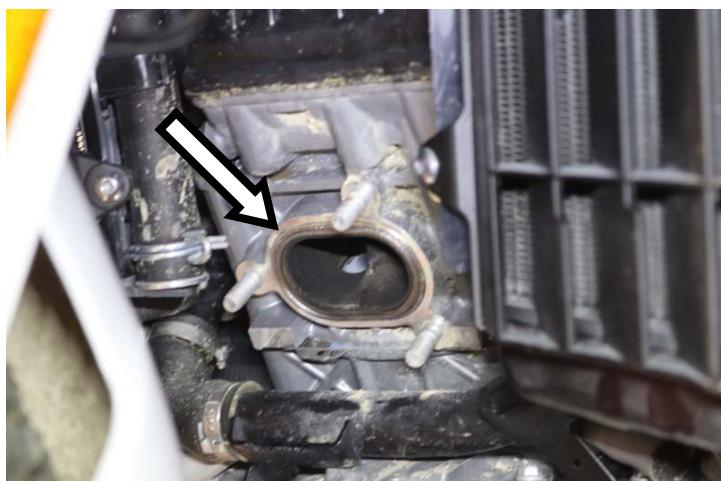
**IT** · Verificare che la guarnizione al cilindro anteriore sia correttamente posizionata nella propria sede
