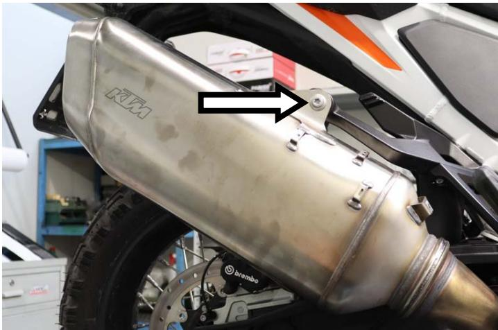
**IT** · Svitare la vite di fissaggio e rimuovere il terminale
