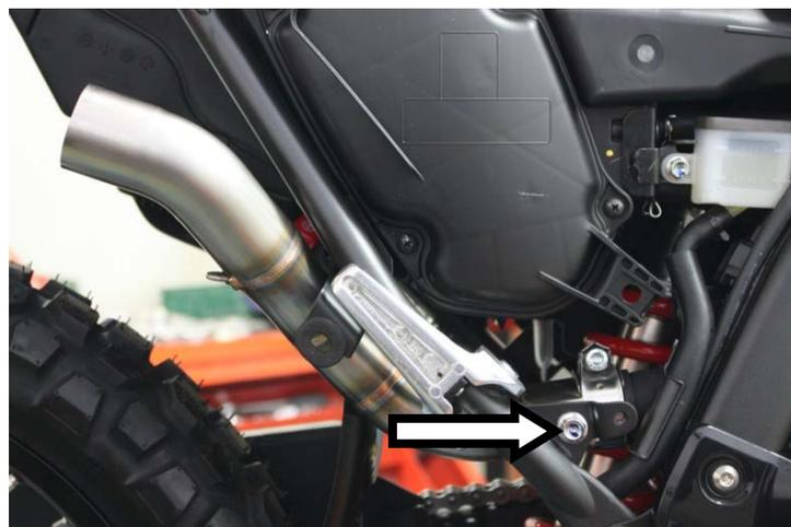
**IT** · Solo per terminali Arrow: Innestare il raccordo e serrare senza stringere completamente l'attacco al telaio
