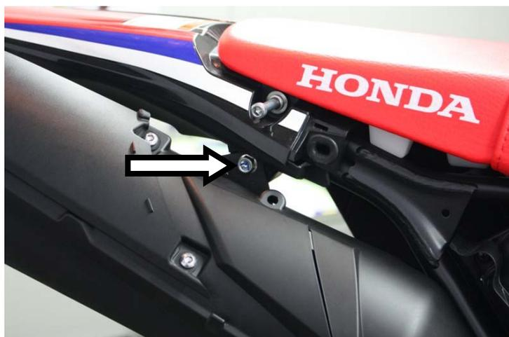
**IT** · Solo per terminale originale: Innestare il terminale e serrarlo senza stringere completamente al telaio
