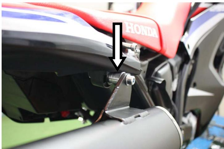
**IT** · Solo per terminali Arrow: Innestare il terminale e serrare senza stringere completamente l'attacco interponendo col telaio lo spessore
