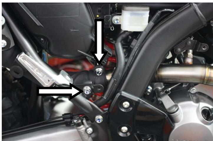
**IT** · Solo per terminale originale: Serrare la fascetta e l'attacco del raccordo. Serrare definitivamente terminale e collettore al cilindro
