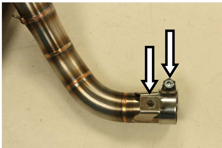
**IT** · Solo per terminali Arrow: Inserire la fascetta nell'innesto del raccordo e la clip nell'attacco
