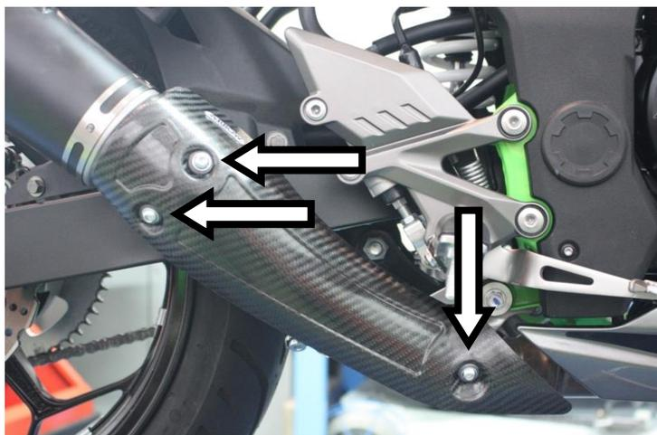
**IT** · Fissare la protezione posizionando le altre rondelle para calore (3) a contatto con essa
