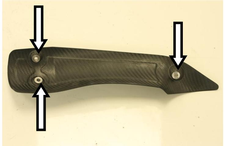
**IT** · Inserire nei fori della protezione lato interno gli spessori comprensivi di rondelle para calore
