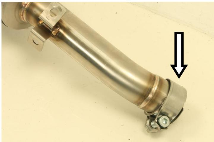
**IT** · Alloggiare la fascetta di serraggio nell'innesto del terminale
