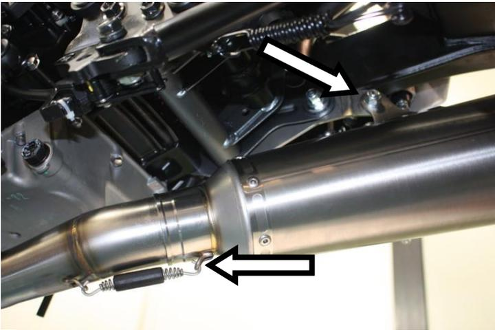
**IT** · Innestare il terminale, serrare l'attacco nel lato interno della staffa ed ancorare la molla
