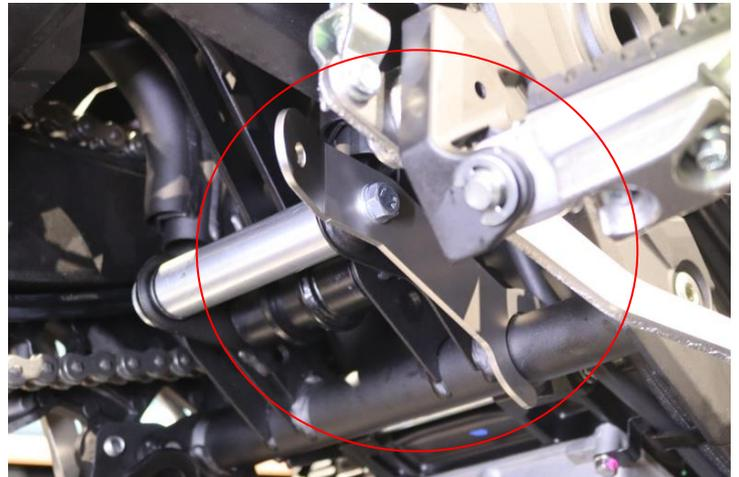
**IT** · Fissare all'esterno del bussolotto DX mediante vite TE M8x35 e relativa rondella la staffa di fissaggio terminale come mostrato in foto
