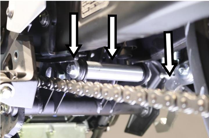
**IT** · Posizionare il distanziale tra i due attacchi e fissarlo nel lato esterno SX utilizzando l'altro bussolotto, una vite TE M8x35mm e relativa rondella
