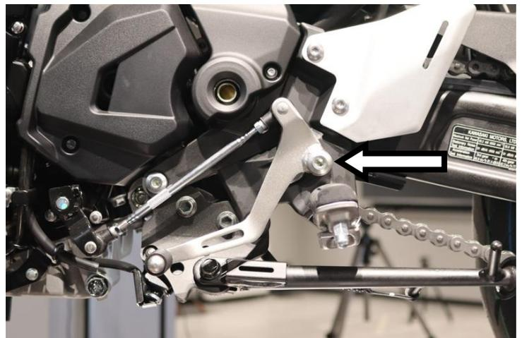
**IT** · Rimontare il pedalino del cambio come in origine
