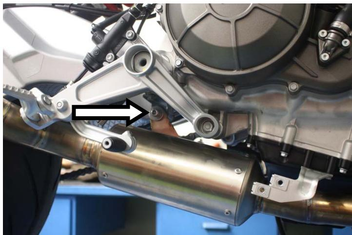
IT · Innestare il raggruppamento, serrare senza stringere completamente l'attacco al telaio ed ancorare le due molle
