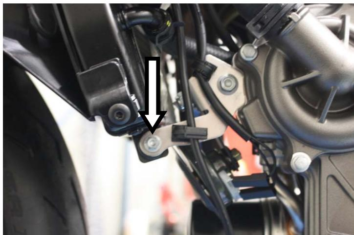
**IT** · Riavvitare la vite di fissaggio radiatore
