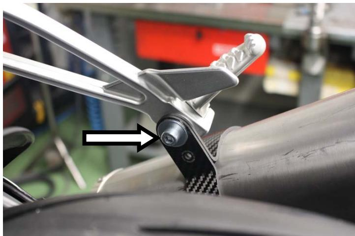
IT · Innestare il terminale, serrarlo alla pedana mediante fascetta ed ancorare la molla
