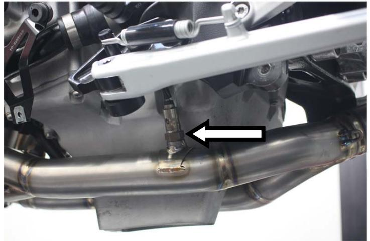
**IT** · Avvitare la sonda lambda posteriore SX e riposizionare i cavi nel supporto
