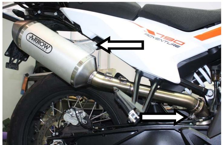
**IT** · Innestare il terminale, serrare senza stringere completamente l'attacco al telaio e la fascetta
