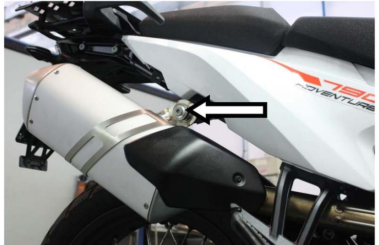
**IT** · Svitare la fascetta, la vite di fissaggio e rimuovere il terminale
