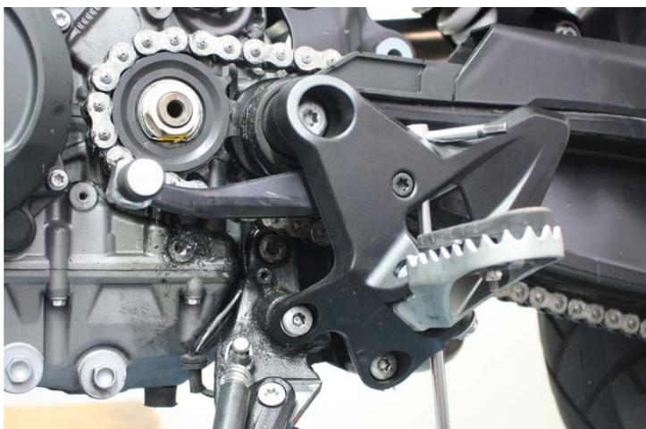
**IT** · Rimontare il cavalletto ed avvitare il forcellone con le coppie di serraggio indicate dal costruttore
