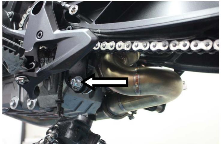
**IT** · Innestare il raccordo Dekat, serrare senza stringere completamente la fascetta e l'attacco al telaio
