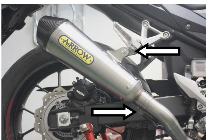
**IT** · Innestare il terminale X-Kone, serrare senza stringere completamente l'attacco nel lato esterno della pedana ed ancorare la molla
