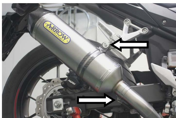
**IT** · Innestare il terminale Race Tech, serrarlo senza stringere completamente mediante fascetta nel lato esterno della pedana ed ancorare la molla
