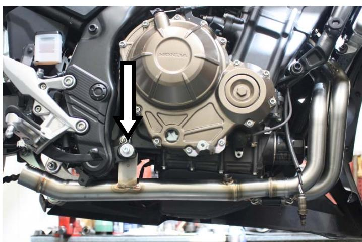
**IT** · Innestare il raccordo e serrare senza stringere completamente l'attacco nel lato interno del telaio
