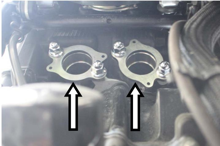
**IT** · Innestare le boccole e fissarle senza serrare completamente mediante le flange ai prigionieri dei cilindri come mostrato in foto
