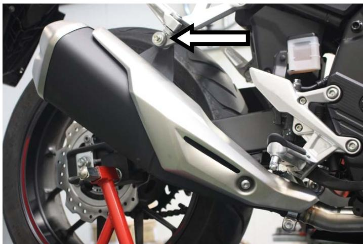
**IT** · Innestare il terminale originale e serrare senza stringere completamente l'attacco nel lato interno della pedana
