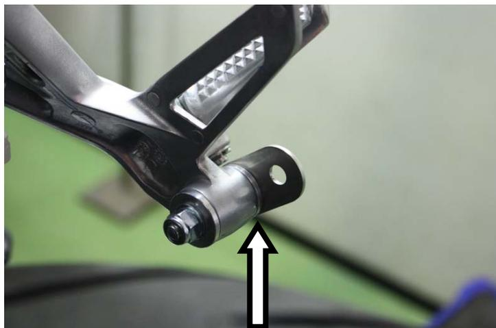
**IT** · Solo per terminale Pro-Race: Montare senza serrare completamente all'esterno della pedana la staffa di sostegno
