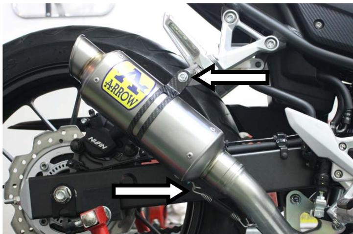
**IT** · Innestare il terminale GP2, serrarlo alla pedana mediante fascetta ed ancorare la molla
