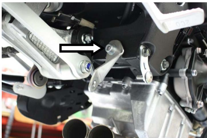
**IT** · Fissare al telaio la staffa fornita
