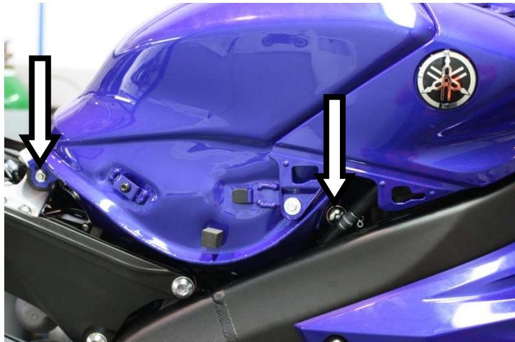
**IT** · Svitare la vite indicata ed allentare la vite di fissaggio serbatoio posta sotto alla sella
