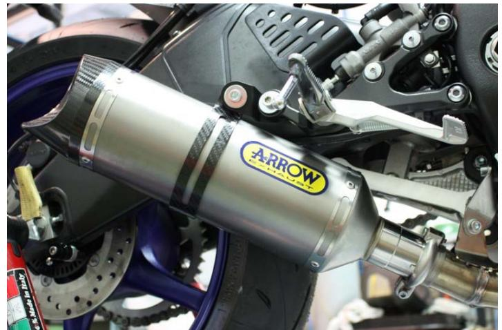
**IT** · Solo per terminali Thunder: Innestare il terminale, serrarlo alla staffa mediante fascetta di sostegno ed avvitare la fascetta originale. Rimontare le carene
