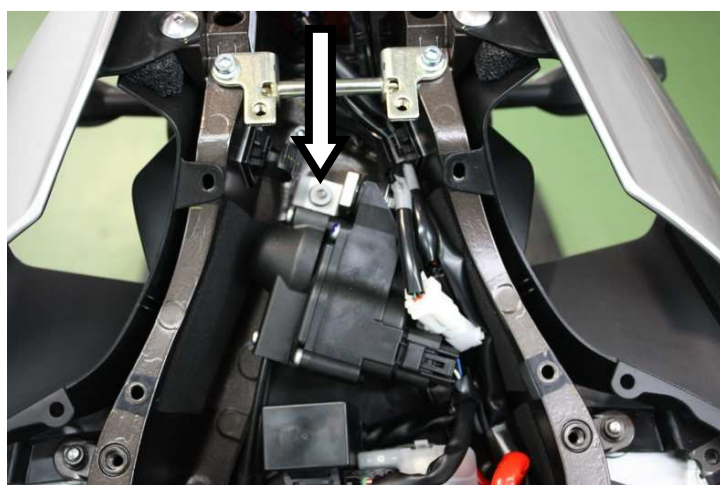
Svitare la vite indicata ed estrarre il motore attuatore valvola Unscrew the screw shown above and pull out the valve actuator engine
