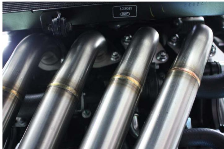
**IT** · Innestare i collettori sui cilindri a partire dal n° 1 e serrare senza stringere completamente le flange ai prigionieri mediante dadi originali
