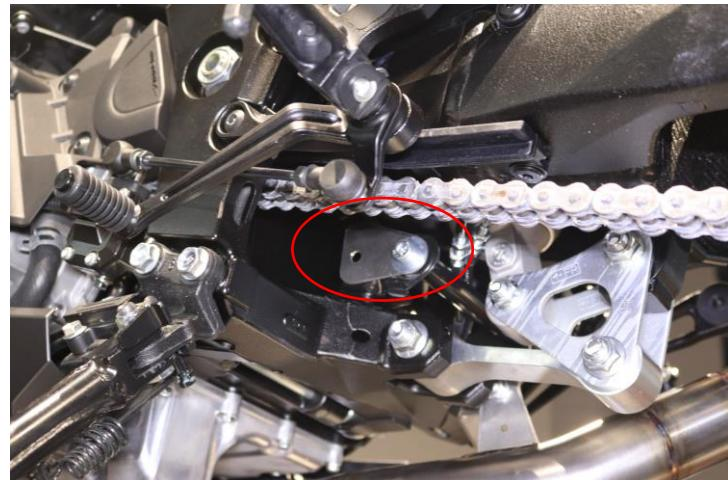
**IT** · Assemblare vite, rondella e staffa fornite come mostrato in foto e posizionarle nel lato SX della staffa originale di fissaggio terminale
