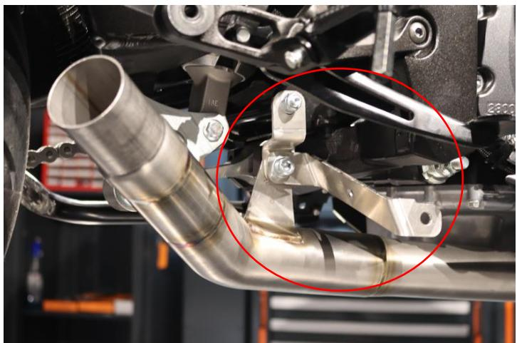
**IT** · Serrare senza stringere completamente nel lato esterno della staffa di fissaggio raccordo la staffa per la protezione ed in quello interno l'attacco del raccordo
