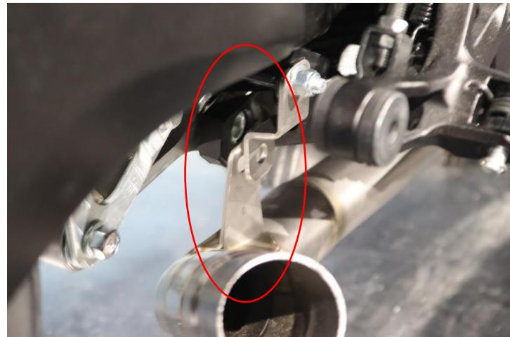
**IT** · Innestare il raccordo posizionando l'attacco nel lato interno della staffa di fissaggio ed ancorare le due molle
