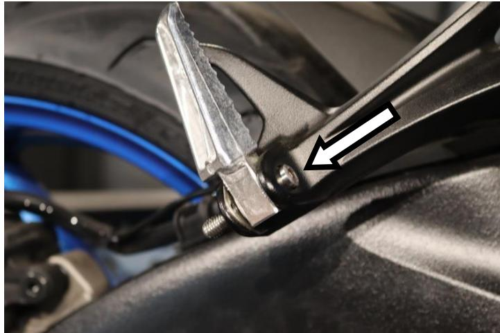
IT · Inserire nel pedalino passeggero DX il perno filettato fornito
