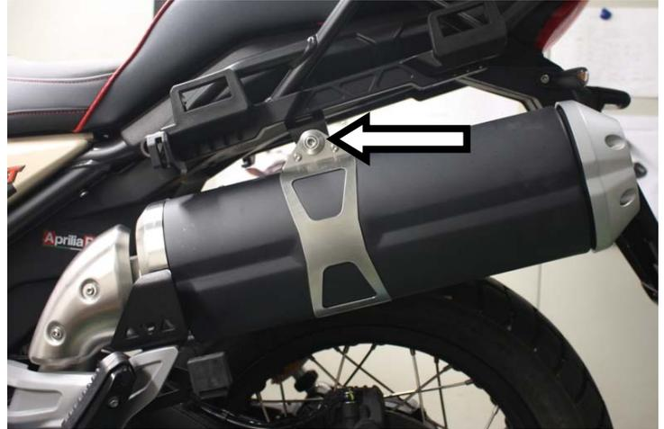
**IT** · Svitare la vite di fissaggio e rimuovere il terminale originale
