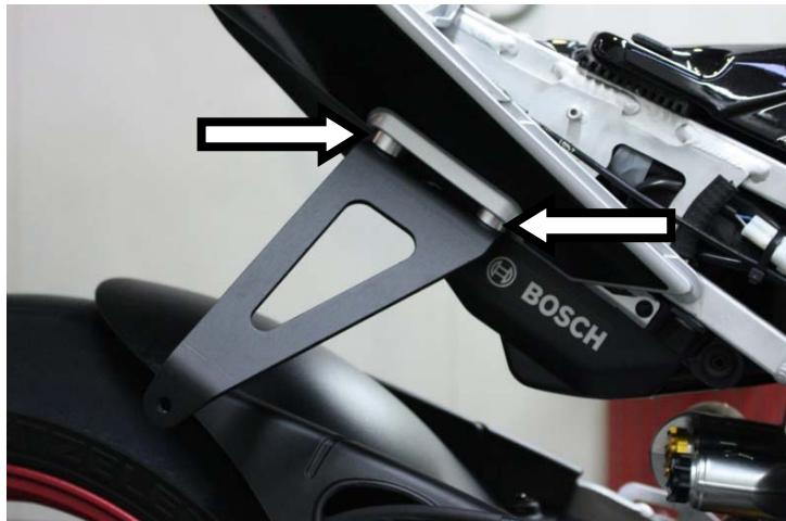
**IT** · Avvitare la staffa di sostegno al telaio interponendo gli spessori (2) forniti
