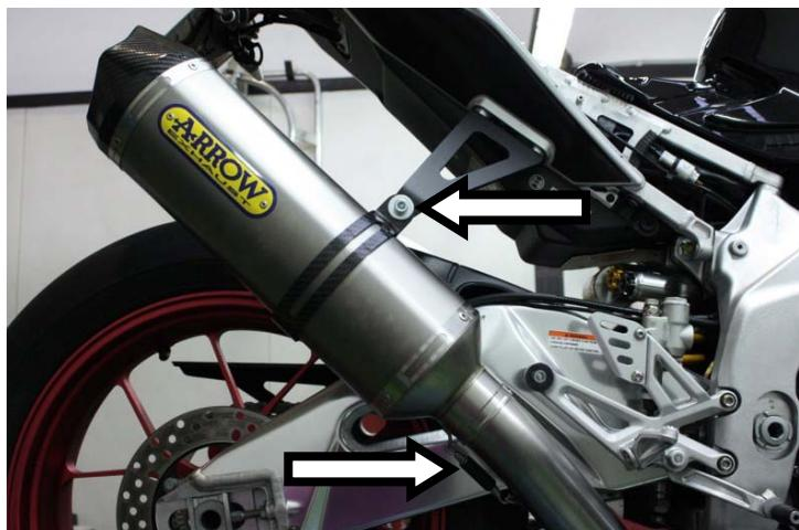
**IT** · Innestare il terminale, ancorare la molla e fissarlo alla staffa mediante fascetta di sostegno
