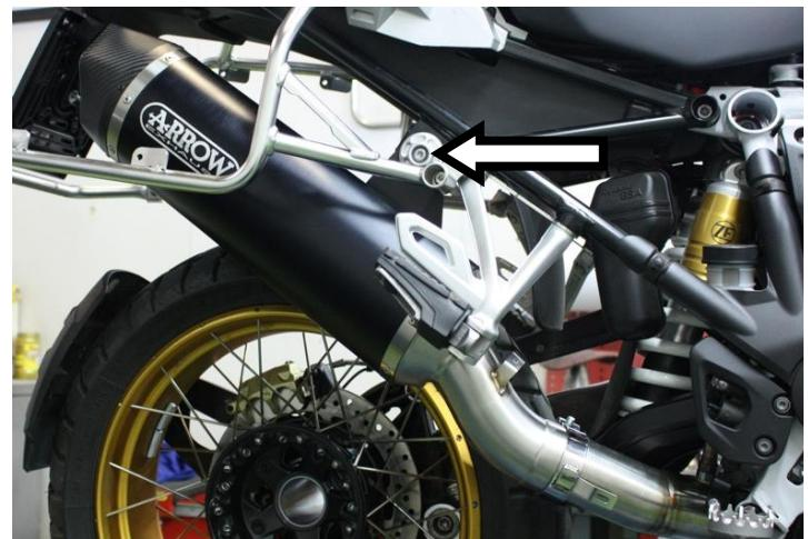
IT · Innestare il terminale Arrow e serrare l'attacco al telaio
