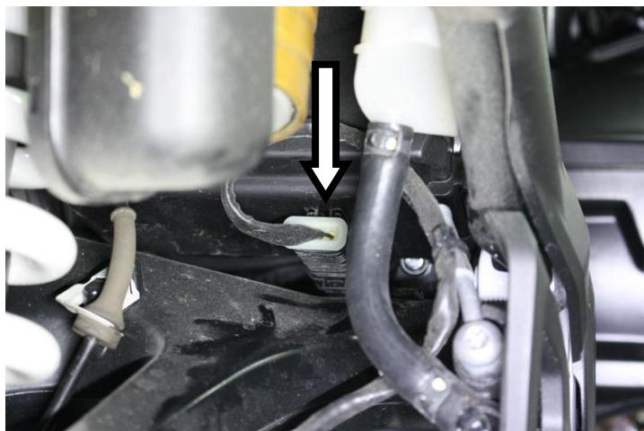
**IT** · Sfilare il connettore della sonda lambda posteriore dal supporto
