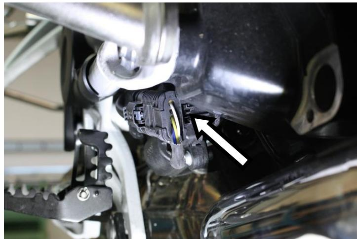
**IT** · Sfilare il connettore della sonda lambda DX dal supporto
