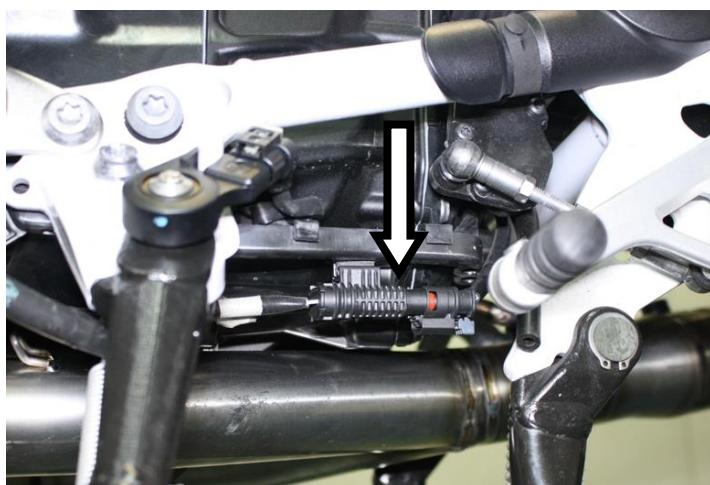
**IT** · Riconnettere il cablaggio della sonda lambda SX e fissarlo al supporto come in origine
