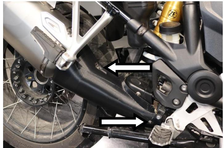
**IT** · Montare la protezione utilizzando la bulloneria fornita
