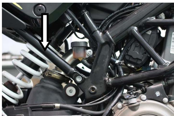
IT · Alloggiare senza montare il collettore secondario Dekat all'interno del telaio e rimontare il serbatoio dell'olio
