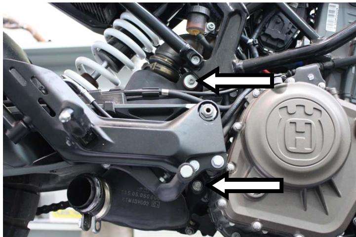
IT · Svitare la vite superiore ed allentare l'inferiore in modo da poter ruotare il gruppo centrale verso il posteriore
