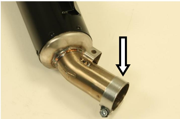
**IT** · Posizionare la fascetta di serraggio nell'innesto del terminale
