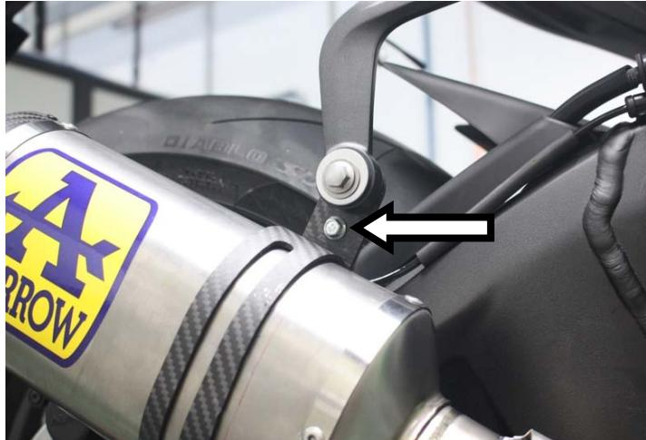
**IT** · Serrare la fascetta sul corpo utilizzando la vite M5 ed il dado forniti nel kit di montaggio
