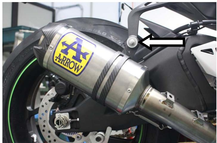
**IT** · Innestare il terminale Indy Race, serrarlo all'interno della pedana mediante fascetta di sostegno ed ancorare la molla
