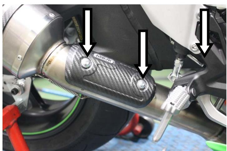
**IT** · Montare la protezione con la sequenza riportata di seguito
