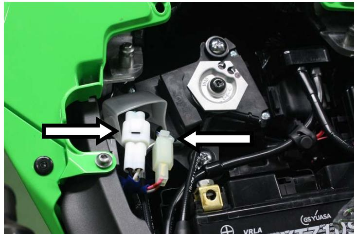
**IT** · Disconnettere i cablaggi (2) e montare l'ingannatore valvola (rimuovere o meno il motorino attuatore valvola)
