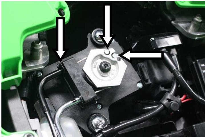
**IT** · Togliere il fermo e sfilare i cavi di comando (2) dal motore attuatore valvola
