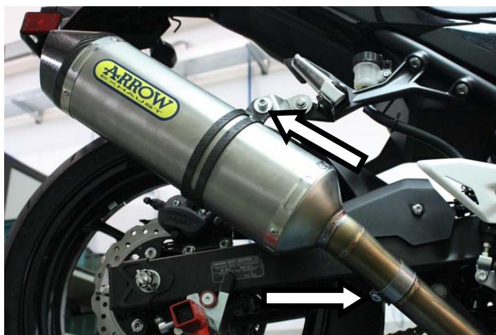
**IT** · Fissare il terminale alla staffa mediante fascetta e serrare la fascetta tra terminale e raccordo
