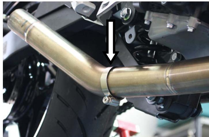
**IT** · Solo per terminale originale: inserire nel raccordo la fascetta originale per il fissaggio della protezione
