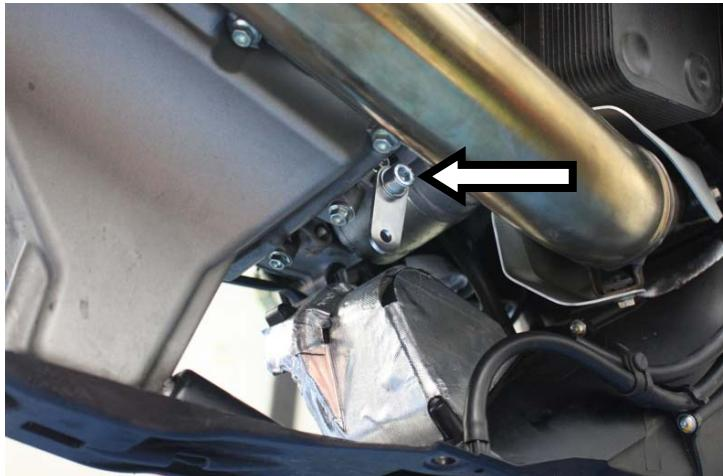
**IT** · Avvitare senza serrare completamente la staffa di sostegno raggruppamento al motore
