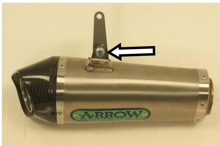
IT · Avvitare senza serrare completamente la staffa di sostegno al terminale DX
