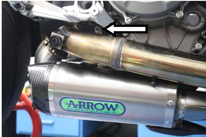
**IT** · Innestare il terminale DX e serrare senza stringere completamente la staffa di sostegno al motore
