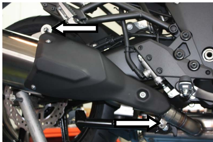
Allentare la fascetta, svitare la vite e rimuovere il terminale originale Loosen the clip, unscrew the bolt and remove original silencer
