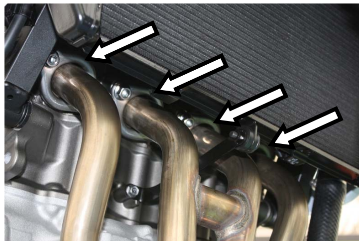
Svitare i dadi (8) dai prigionieri dei cilindri Unscrew the nuts securing silencers to the cylinders
