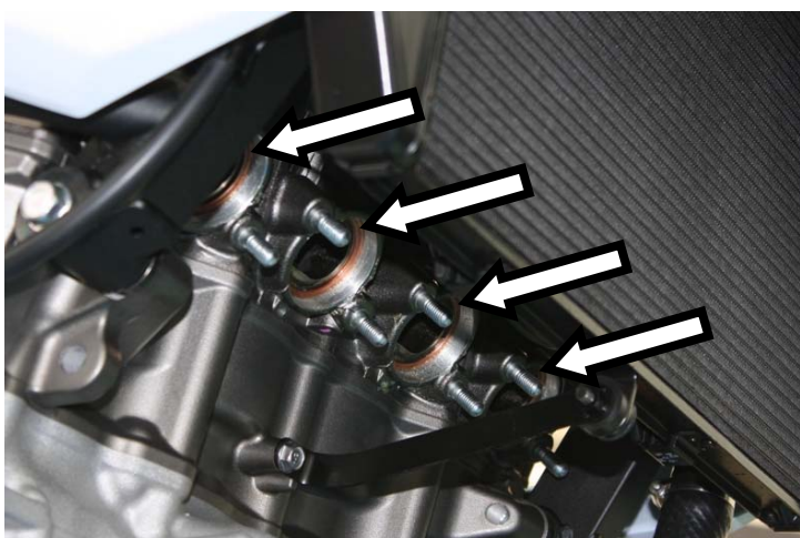
Verificare che le guarnizioni ai cilindri siano correttamente posizionate nelle rispettive sedi Check the original gaskets to be properly positioned in their seats
