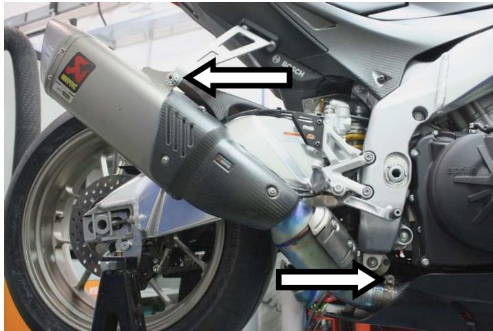
**IT** · Allentare la fascetta, svitare la vite di fissaggio e ruotare il terminale verso l'esterno in modo da poter scollegare la valvola
