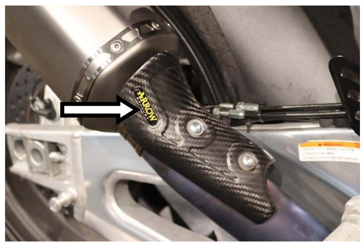
**IT** · Montare ed adesivare la protezione
