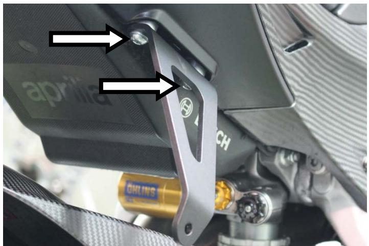
**IT** · Avvitare la staffa di sostituzione interponendo col telaio gli spessori forniti
