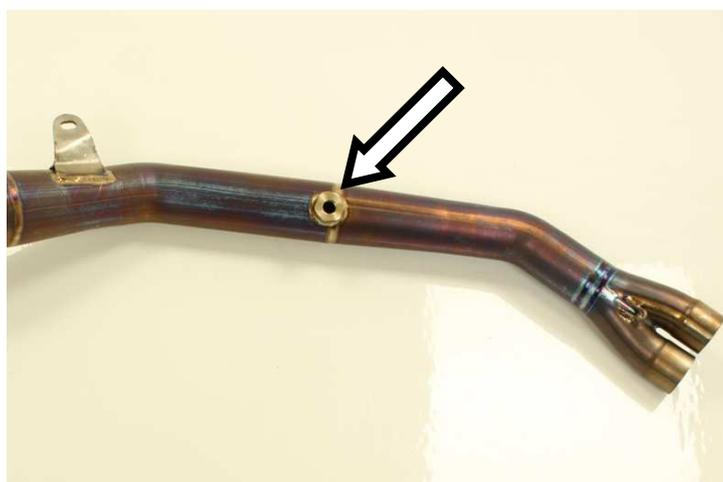
Avvitare la riduzione sonda lambda nel raccordo
