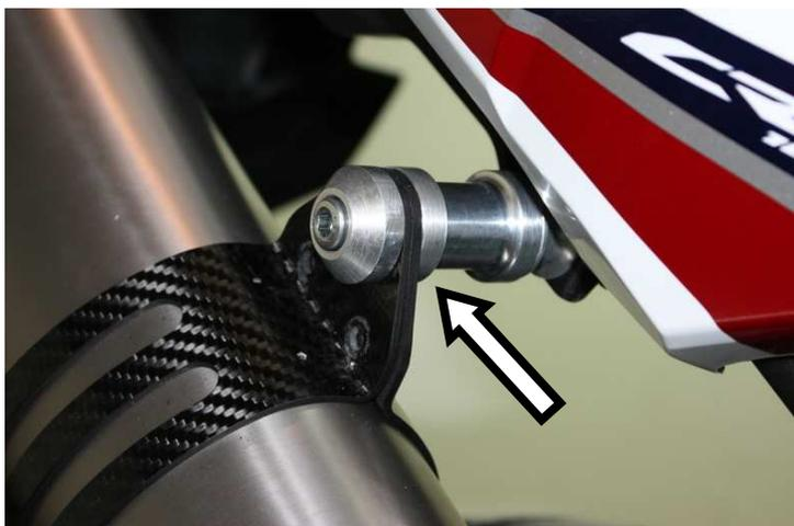
Serrare il terminale mediante fascetta interponendo col telaio lo spessore
