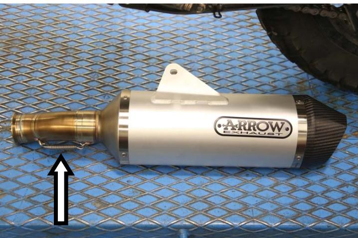
**IT** · Pre-assemblare il raccordo col terminale ed ancorare la molla
