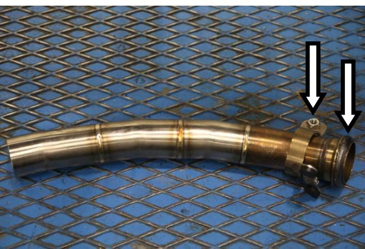
IT · Posizionare guarnizione e fascetta originali nel collettore di sostituzione
